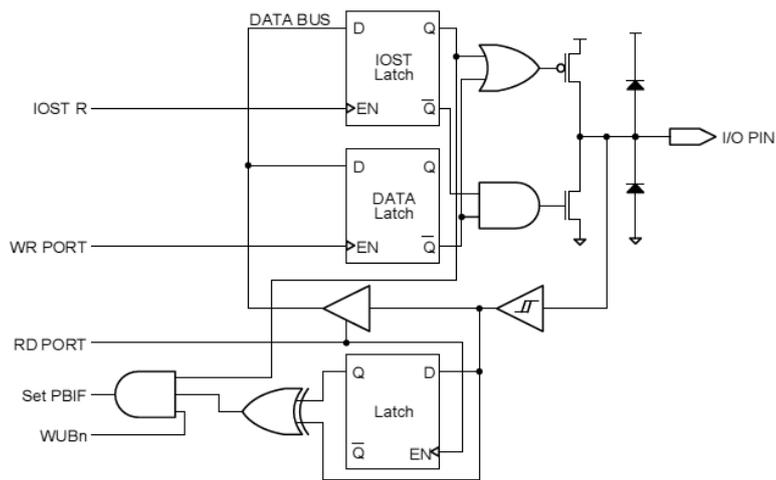
上拉/下拉和漏极开漏在图中未显示
